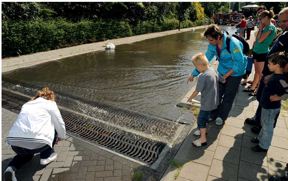
Figuur 7.9 Test opvangcapaciteit: circa 70 m 3 water in enkele minuten op straat geloosd.
